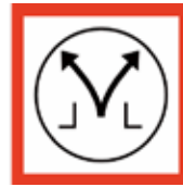
Bedienstelle Rauch-, Wärmeabzug
